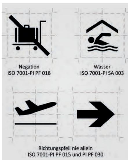
ABB. 03 Symbole aus ISO 22727: Gestaltungsrichtlinien angewendet. QUELLE Marco Jänicke
