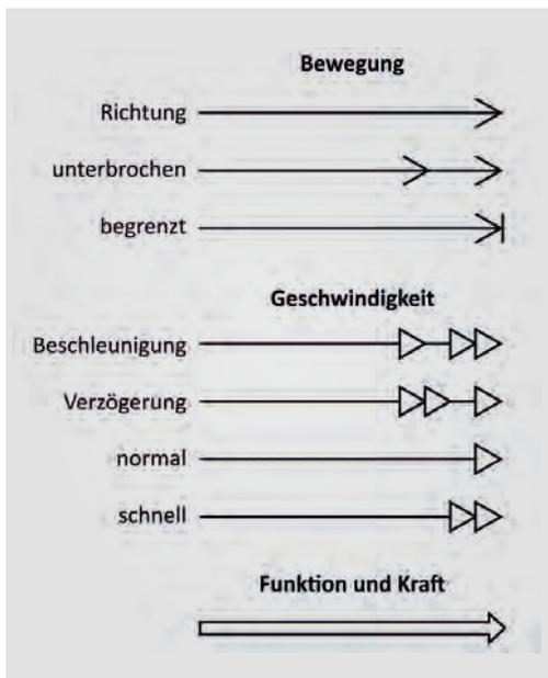
ABB. 14 Symbole auf Einrichtungen: Pfeile. QUELLE Marco Jänicke
