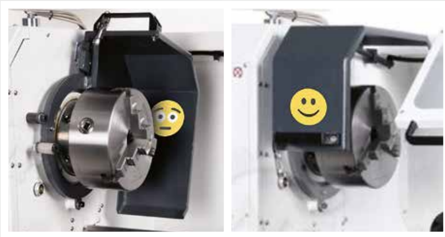
ABB. 06 Nudge an einer Schutzeinrichtung. QUELLE www.maschinensucher.de ; Marco Jänicke
